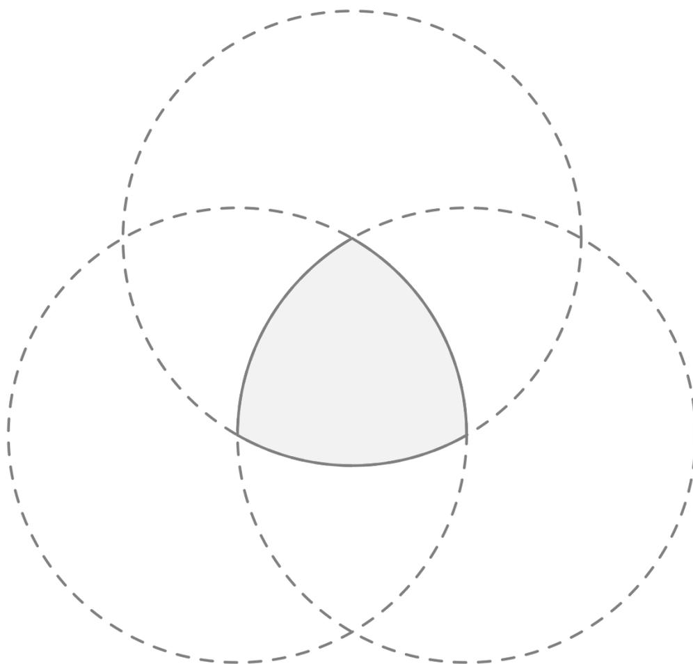
Среди прочих фигур постоянной ширины треугольник Рёло выделяется рядом экстремальных свойств: наименьшей площадью, наименьшим возможным углом при вершине, наименьшей симметричностью относительно центра. Треугольник получил распространение в технике — на его основе были созданы кулачковые и грейферные механизмы, роторно-поршневой двигатель Ванкеля и даже дрели, позволяющие сверлить (фрезеровать) квадратные отверстия.
