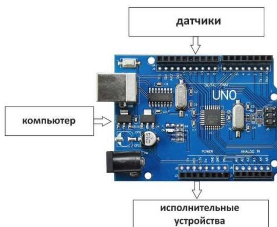
Рисунок 3. Плата Arduino и компьютер
