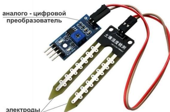
Рисунок 5. Общий вид датчика влажности почвы.
