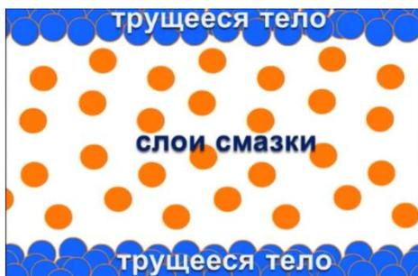
Рисунок 8. Использование смазки для снижения силы трения
