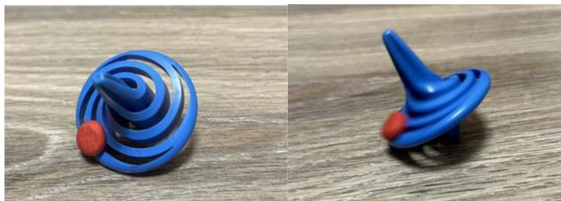
Рисунок 13. Опыт с волчком со смещенным центром массы
